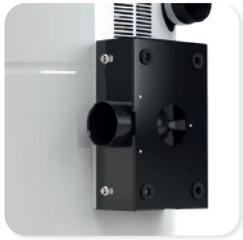
La staffa posteriore che **integra la curva tecnica Revers** riceve direttamente il tubo 50/Ø51 o il maschio di una curva MF Ø50/Ø51. E' orientabile su 4 lati consentendo la massima flessibilità di gestione dei tubi, specialmente nel completamento di impianti già esistenti con tubi a vista.
