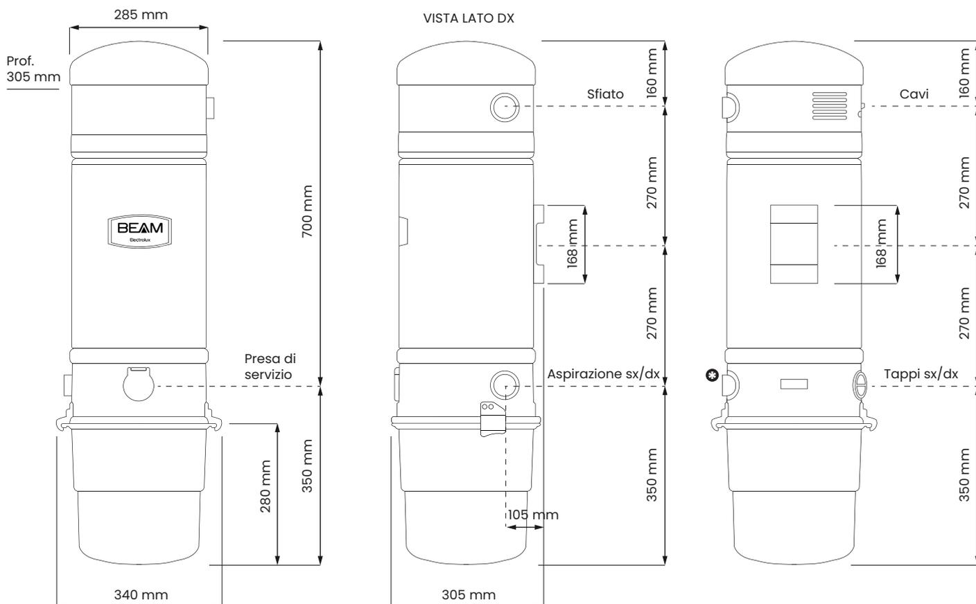
Il raccordo di aspirazione è posizionabile in 2 lati diversi, sia su lato SX che DX (nel lato disimpegnato, è presente un tappo con guarnizione). Connessione sia su tubo rigido Ø50 che Ø51.
